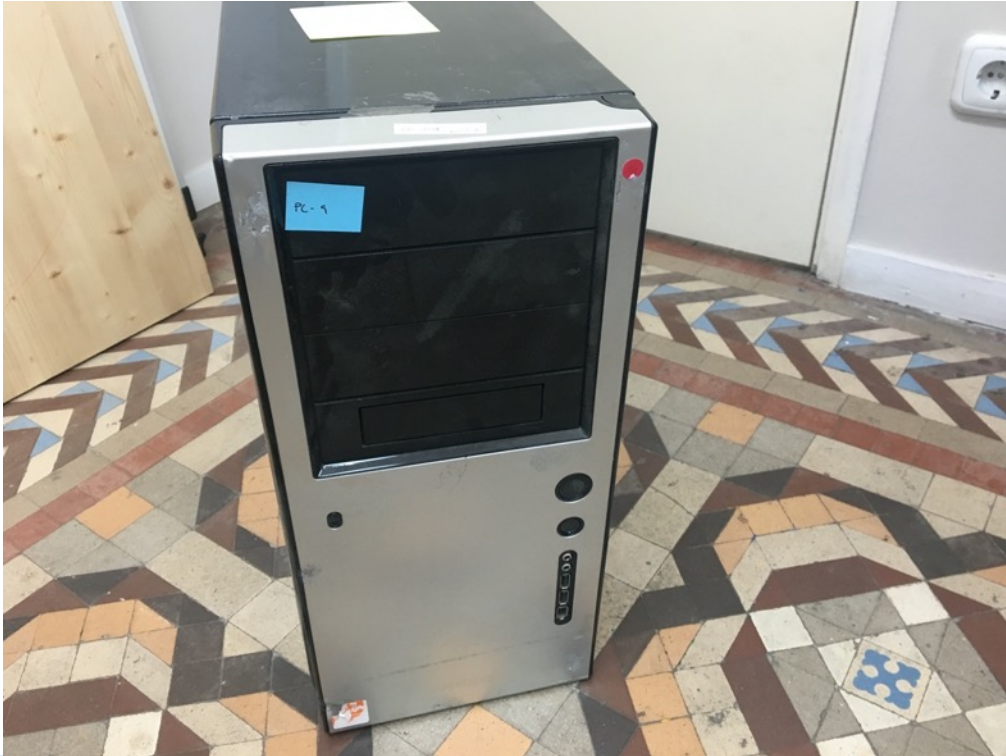
PC "Artemisa" AMD 3x 4GB DIMM SSD 250GB Funcionando con Linux Ubuntu Instalado
